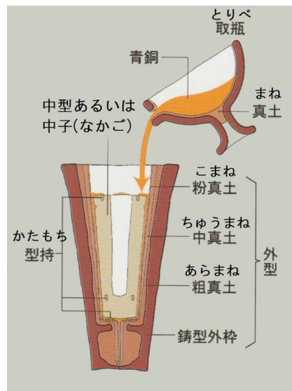
図3 土製鑄型の構造図。文献(2)より引用改変。(オンラインカラー)
