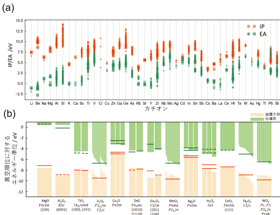
図3 第一原理計算による二元系酸化物のIP・EAの分布と実験との比較. (a) 第一原理計算による二元系酸化物のIP・EAの分布 (b) 実験値との比較. オレンジと緑の実線は、それぞれ実験的に報告されたIPとEAであり、破線は実験的なIPまたはEAと実験的なバンドギャップを組み合わせ導出したものである。(オンラインカラー)
