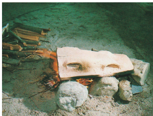
図9 鋳型表面を焼き締める肌焼きの作業。文献(4)より引用。 (オンラインカラー)
