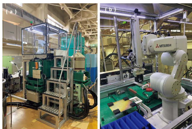
図4 JRR-3に設置された即発 \gamma 線分析装置(PGA)の全景 (a) および多関節ロボット (b)。(オンラインカラー)
