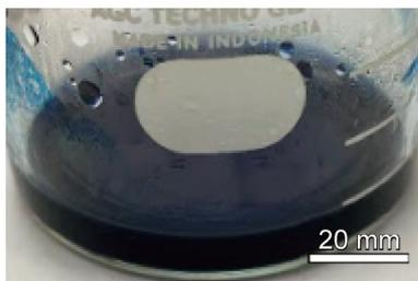
図3  $K_4[Fe(CN)_6]$ により濃青色沈殿を生じた様子。(オンラインカラー)
