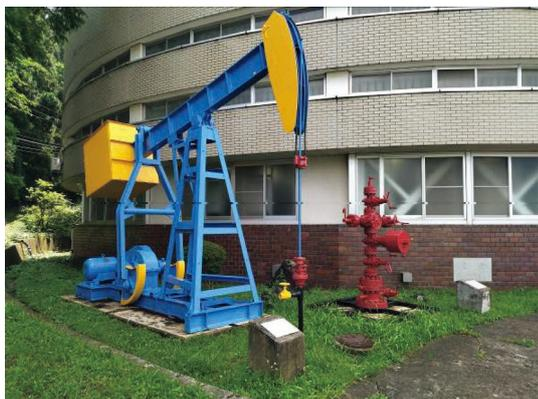
図2 石油の汲み上げ用ポンプ(左)と石油井戸の圧力調整弁(右).
