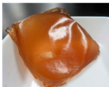
図5 柿渋とCNFで作製したフィルム。(オンラインカラー)
