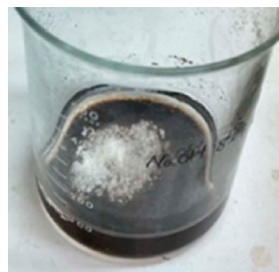
図3 アルミ缶を溶かした水酸化ナトリウム水溶液の黒色沈殿と白色沈殿。(オンラインカラー)
