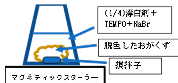
図2 TEMPO酸化の実験装置。(オンラインカラー)
