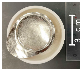
図1 フラックス法に利用した蓋つき白金るつぽと酸化アルミニウムを入れたアルミナるつぽの様子。(オンラインカラー)
