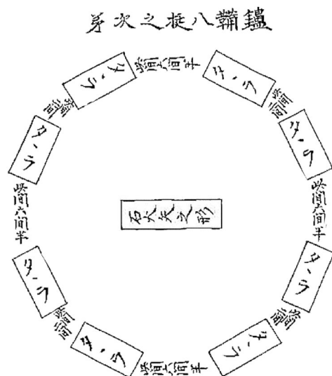
図7 甌(タタラと記されている)8基操業による大砲{石火矢之形(型)}铸造の図 (15) .
