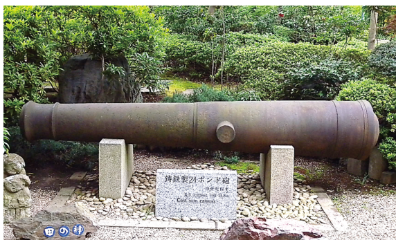
図2 佐賀の24ポンド砲(戸栗美術館蔵, 全長3025 mm, 口径148 mm, 重量2890 kg) (5) . (オンラインカラー)
