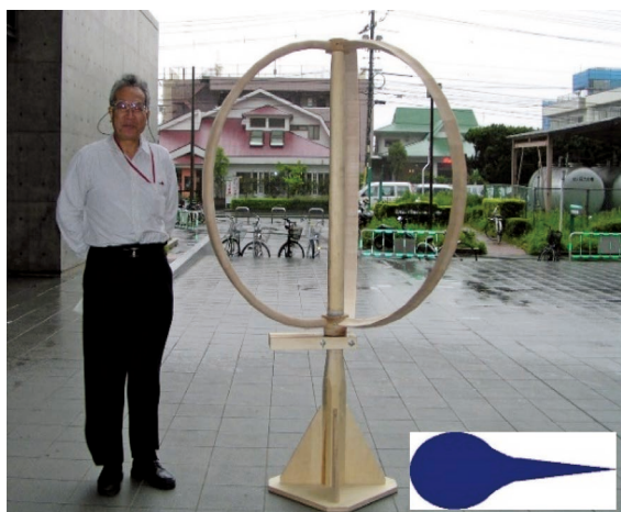
図1 鉛直回転軸の3枚羽ダリウス型風車。(オンラインカラー)
