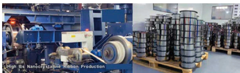
図3 自動制御された液体急冷オペレーション。
