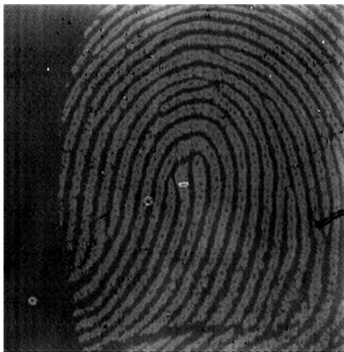
図 2 フレキシブル有機イメージャーで撮像した指紋画像。個人保護のために一部に加工を施している。
