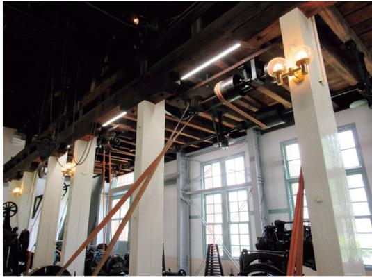
図3 メインシャフトによる動力伝達機構.
