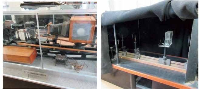
図4 金属組織顕微鏡組織写真撮影装置.
