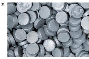
元素名:Rhenium,原子番号:75,原子量:186.2,電子配置:[Xe] 4f<sup>14</sup>5d<sup>5</sup>6s<sup>2</sup>,密度:21.023 Mg·m<sup>-3</sup>(299 K),結晶構造:最 密六方晶,融点:3453 K,沸点:5900 K<sup>(1)</sup>,地殻存在量:0.188 ng·g<sup>-1 (2)</sup>【写真】(a) レニウムを含むニッケル基超合金を使用 したジェットタービン概略図, (b) レニウムペレット(Umicore S.A. 提供).
