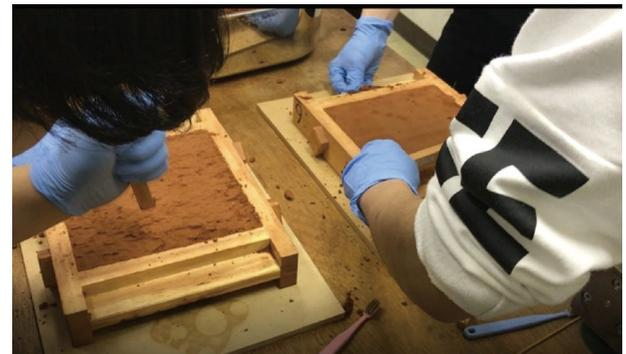
図3 突き固め作業.
