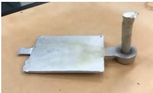
図7 型ばらし, 砂除去後の鋳物の外観.
