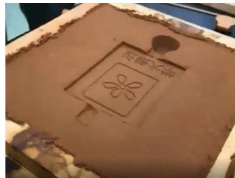
図4 抜型後の下型の外観.
