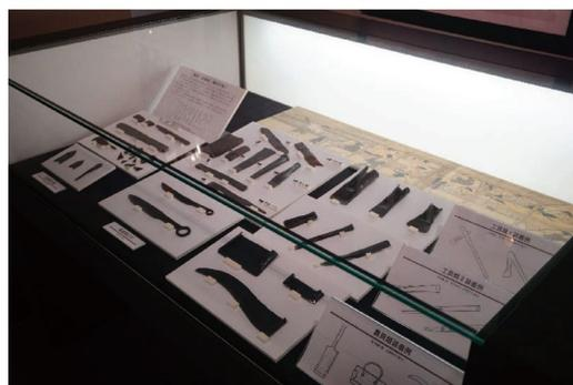
図5 (上)復元実験により得られた鋼を鍛えた日本刀。上段の展示品は日刀保たたらの木原明氏提供による玉鋼、
