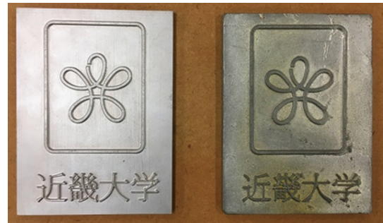
図8 模型(左)と鋳物(右)の外観.
