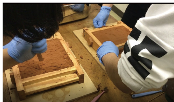
図3 突き固め作業。
