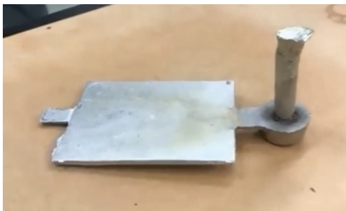
図7 型ばらし, 砂除去後の鋳物の外観.
