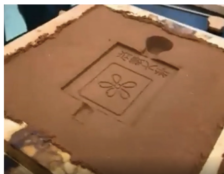
図4 抜型後の下型の外観。
