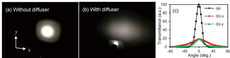
図13 (a, b) LED 光源のスクリーン投影像で光拡散板の有無の比較。(c) (a, b)で透過率の角度分布測定結果。Reproduced with permission from (12), (c) The Optical Society. (オンラインカラー)
