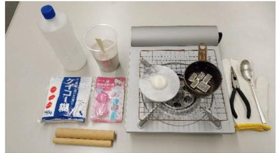
図2 「洗濯のり」を用いた砂型実習教材の外観図。左上から合成洗濯のり(PVA), 粉末洗濯のり( $\alpha$ デンプン), 珪砂+カップ, 模型, 砂型成型用の棒, カセットコンロ, 耐熱コースターに貼り付けた模型, 金属溶解用の器(ステンレス計量カップ)+金属スズ, その他。
