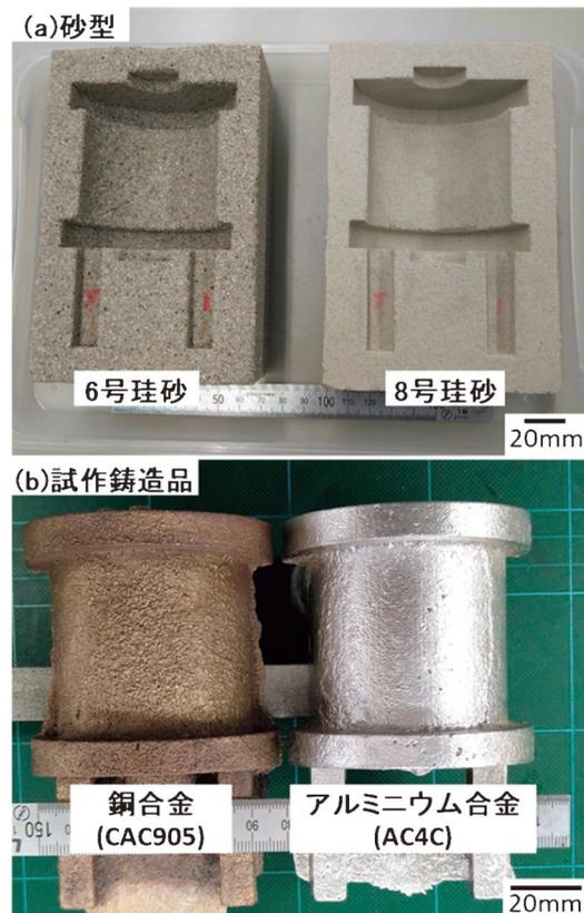
図10 複雑形状鑄物の砂型(a)と試作鑄造品(b)。
