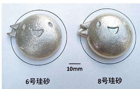
図8 作製した鋳造材の外観図。題材は兵庫県のマスコットである“はばたん”<sup>(23)</sup>。左は6号珪砂、右は8号珪砂を利用した砂型を用いて作製した鋳造材。砂の粒度が大きすぎると、目や口の造形が難しいことが良く分かる。
