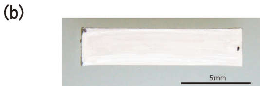
図4 3YSZにおける(a) 直流フラッシュ焼結体断面写真, および(b) 交流フラッシュ焼結体断面写真. 文献(28)より引用. (オンラインカラー)
