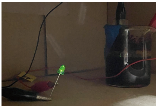
図2 作製したマグネシウム電池(電池3)により発光するダイオード。(オンラインカラー)
