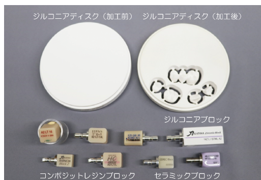
図2 CAD/CAMで歯冠修復物を製作するためのジルコニアディスク(加工前)と加工後のディスク，および各社のコンポジットレジンブロック，セラミックブロック。(オンラインカラー)
