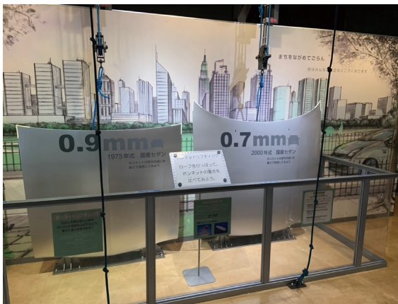
図3 自動車用鋼板の厚みの差による重さの差。
