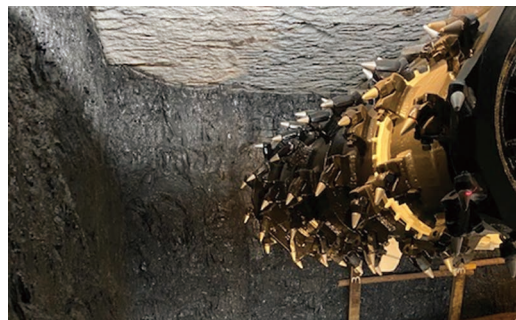
図4 超硬合金の刃先のついた回転式カッターの外観。
