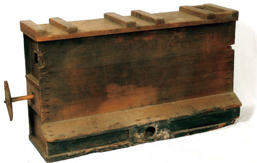
図2 鍛冶屋で利用されていた典型的な飛ゴ (2) 。(オンラインカラー)
