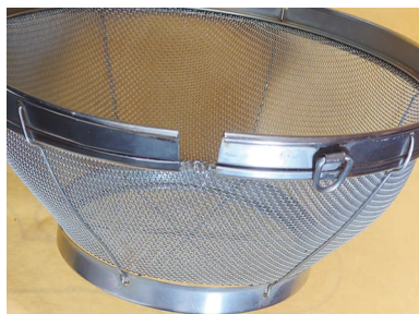
図2 ステンレス鋼製のザル縁部分の破断。(オンラインカラー)
