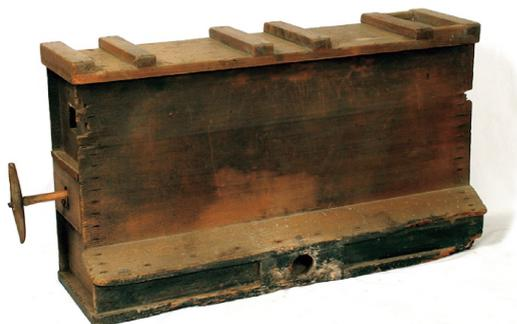
図2 鍛冶屋で利用されていた典型的なフィゴ<sup>(2)</sup>。(オンラインカラー)
