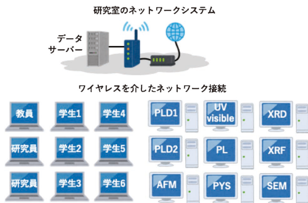
図9 コンビナトリアル手法で得られるデータを管理するネットワークシステム。ワイヤレスを介して, 実験装置から得られたデータをデータサーバーに蓄積するシステムを構築している。(オンラインカラー)
