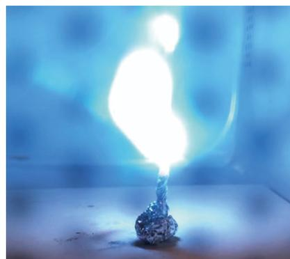
図2 アーク放電発生の様子(酸化アルミニウムと酸化クロム(Ⅲ)を質量比100:1で混合した粉末)。
