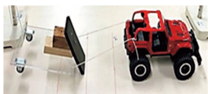
図1 ゴム板でスティックスリップ現象を起こす実験。(オンラインカラー)
