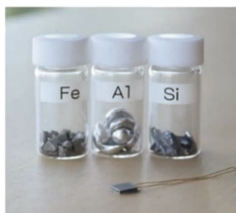
図1 (左)Fe, Al, Si の原材料と FAST 材を用いた小型熱電モジュール, (右)地殻存在量。
