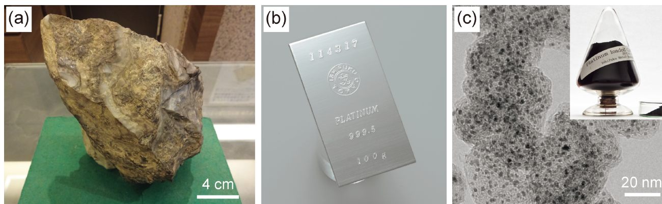
元素名：Platinum，原子番号：78，質量数：195.08，電子配置： [\text{Xe}]4f^{14}5d^96s ，密度： 21.44 \text{ Mg}\cdot\text{m}^{-3} (293 K)，結晶構造：面心立方(室温～融点)，融点：2042 K，沸点：4100 K (1) ，地殻存在量： 1.5 \text{ ng}\cdot\text{g}^{-1} (2) 。【写真】(a)白金鉱石(鉱石1トン当たりPt 2.5 g含有)，(b)Ptインゴット，(c)燃料電池用カーボンブラック担持Ptナノ粒子触媒のTEM像と粉末の写真(すべて石福金属興業株式会社提供)
