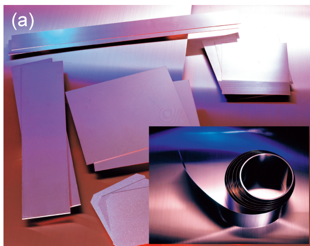
元素名：Molybdenum，原子番号：42，質量数：95.94，電子配置：[Kr]4d 5 5s 1 ，密度：10.222 Mg·m -3 (293 K)，結晶構造：体心立方，融点：2903 K，沸点：5100 K (1) ，地殻存在量：0.8 μg·g -1 (2) 【写真】(a) Mo 板，純度99.95% (特アライドマテリアル写真提供)，(b) MoSiBTiC 合金 (Mo-5Si-10B-10Ti-10C (at %)) の1800℃，24 h 熱処理後の反射電子像。
