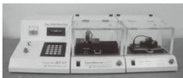
強制振動式内部摩擦測定装置
