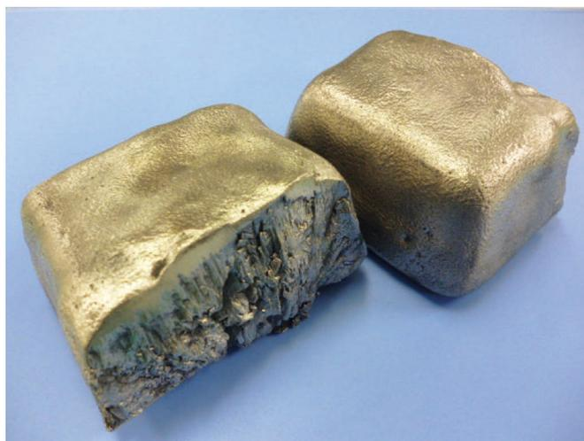
元素名：Neodymium，原子番号：60，質量数：144.24，電子配置： $[\text{Xe}]4f^4 6s^2$ ，密度： $7.000 \text{ Mg}\cdot\text{m}^{-3}$  (293 K)，結晶構造： $\alpha$ -Nd 二重六方 (~1142 K)， $\beta$ -Nd 体心立方 (1142~1298 K)，融点：1298 K，沸点：3400 K<sup>(1)</sup>，地殻存在量： $20 \mu\text{g}\cdot\text{g}^{-1}$ <sup>(2)</sup>
