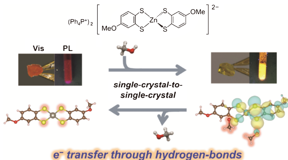
図2 亜鉛ジチオレン金属錯体結晶において、分子間電子移動と水素結合形成が結合した新規な水素—電子カップリング型ペイボクロミズム機構を見出した (1) 。メタノール蒸気にさらすことによりオレンジから黄色への色変化、蛍光色変化が観測された。(オンラインカラー)
