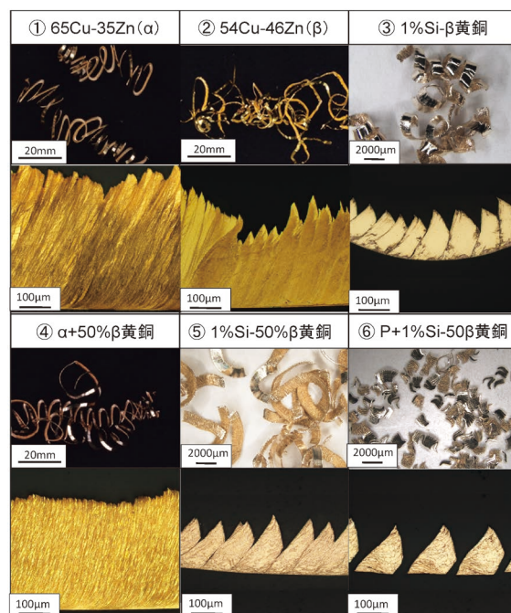
図3 図2における①-⑥の各合金の旋盤外周切削時の切屑の外観と断面。
