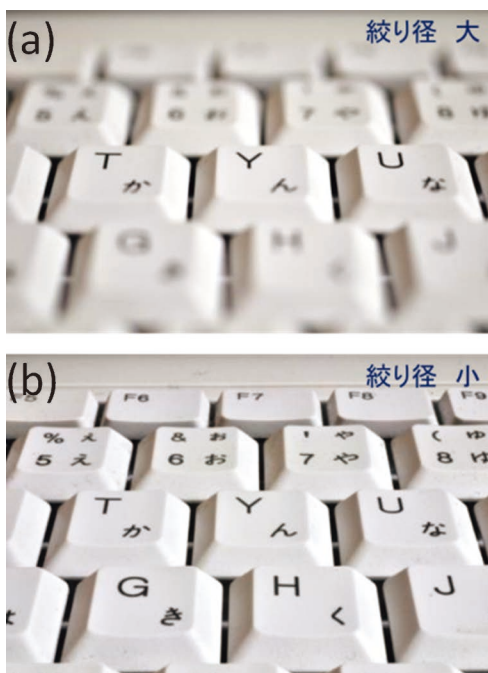
図6 被写界深度の例。 (a)絞りを開放(径を広げています), (b) 絞りを絞っている(径を小さくしています) ここでは一眼カメラを用いてキーボードを斜め上方向から撮影した例で示しています。絞りは、開口絞りに相当します。絞り込むと、ピントが合っている奥行きが増加しています。この状態は、光学顕微鏡の試料観察での表面キズや凹凸がよく見えている状態に相当します。
