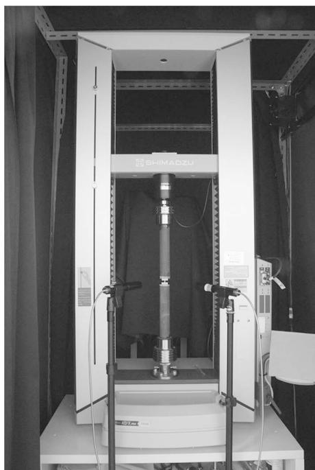
図2 暗幕に囲われた圧縮試験機。
