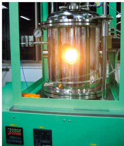
図2 本書を頼りに作製した超高温濡れ性評価装置(2000°Cでの実験風景)。
