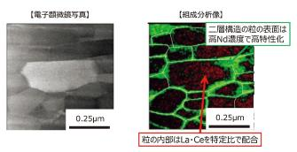
図4 省 Nd 磁石の微細組織構造.
