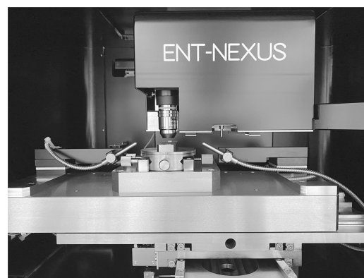
図3 暗幕に覆われたナノインデンテーション試験機。
