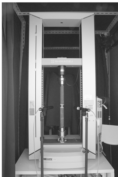
図2 暗幕に囲われた圧縮試験機。
