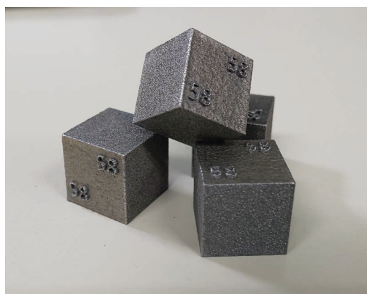
図1 SUS420J2のレーザ積層造形体験片(サイズ: 11 mm×11 mm×11 mm). (オンラインカラー)
