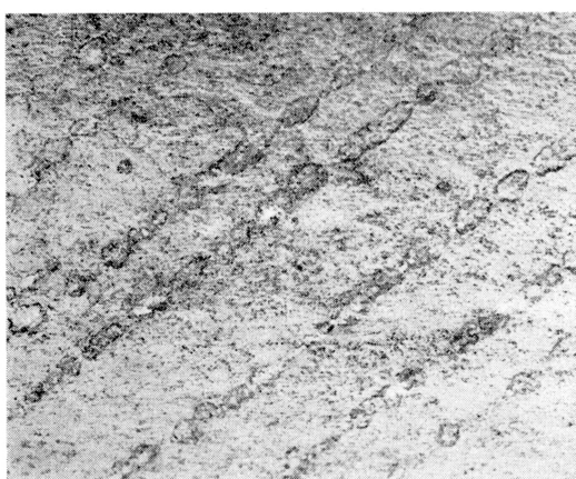
写真3 鋼管のストレッチャストレンに大気中で生じた赤さび(下平,佐藤)
