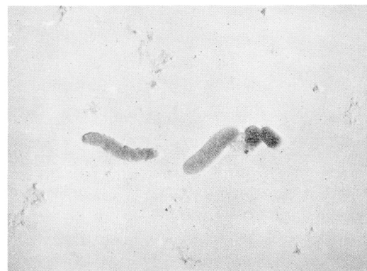
写真2 隅田川口の硫酸塩還元バクテリア (服部, 下平) (×4000) 減できる手段が完成されたとしても、取水口の外から腐食性物質がたえず流入してくるのではどうしようもない。もつとも金属面で硫酸塩還元バクテリアが繁殖すれば、電気化学腐食におけるカソード反応 H + + e - → H の復極剤として働き腐食が促進される。汚水によつて銅合金がさびやすいことは簡単な電気化
