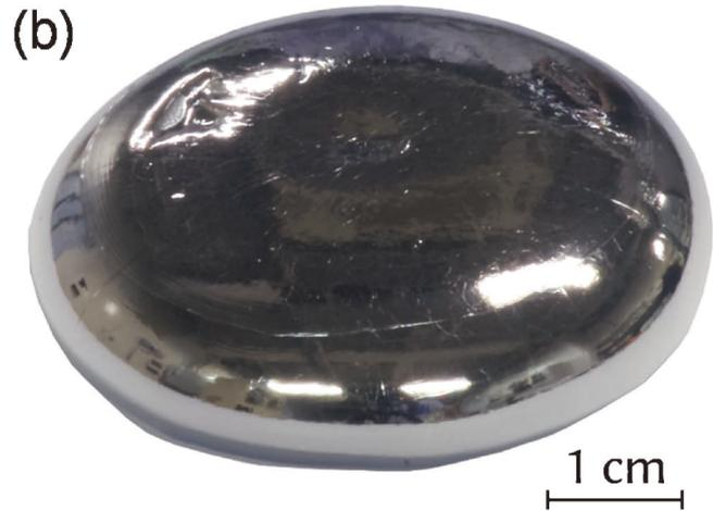
元素名：Iron，原子番号：26，質量数：55.85，電子配置：[Ar] 3d<sup>6</sup> 4s<sup>2</sup>，密度：7.87 Mg·m<sup>-3</sup>(293 K)，結晶構造：α-Fe 体心立方(～1189 K)，γ-Fe 面心立方(1189～1667 K)，δ-Fe 体心立方(1667～1809 K)，融点：1809 K，沸点：3106 K，地殻存在量：6.7 wt%(Fe O 換算)．【写真】(a)電解鉄，純度99.9%，(b)超高純度鉄，純度99.9998% (東北大学 打越雅仁氏 写真提供)
