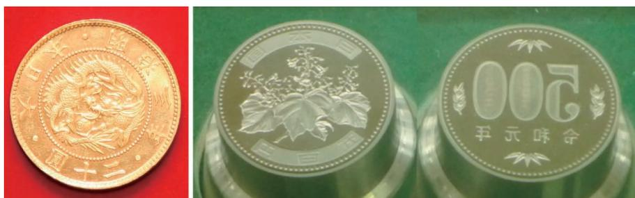
図2 左:加納夏雄が作製した極印によって圧印された二十円金貨のオモテ面の写真。右:現行500円貨幣の極印(展示)。
