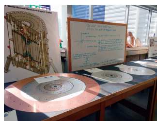
図2 施設公開に展示されている水冷マグネットのビッター盤。
