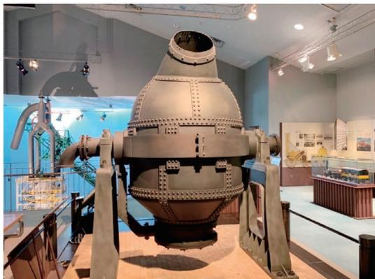
図3 ベッセマー転炉(1/2 模型).
