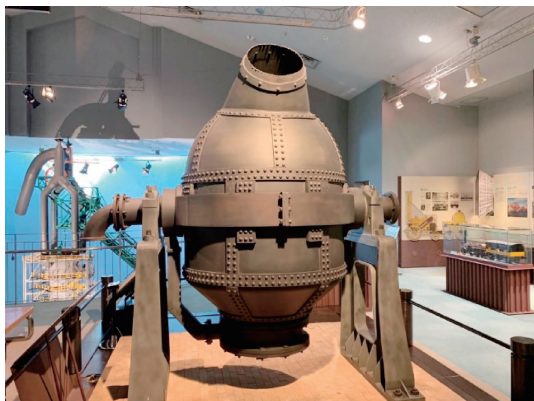
図3 ベッセマー転炉(1/2 模型)。
