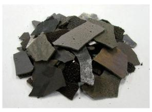
元素名: Manganese,原子番号: 25,質量数: 54.94,電子配置: [Ar]3d5 4s2,密度: 7.473 Mg·m $^{-3}$ (293 K),結晶構造:  $\alpha$ -Mn 立方晶( $\sim$ 1000 K), $\beta$ -Mn 立方晶( $1000\sim$ 1373 K), $\gamma$ -Mn 立方晶( $1373\sim$ 1411 K), $\delta$ -Mn 立方晶(1411 K $\sim$ 融点),融点: 1519 K,沸点: 2334 K $^{(1)}$ 【写真】電解金属マンガン,純度99.9%(新日本電工 写真提供)
