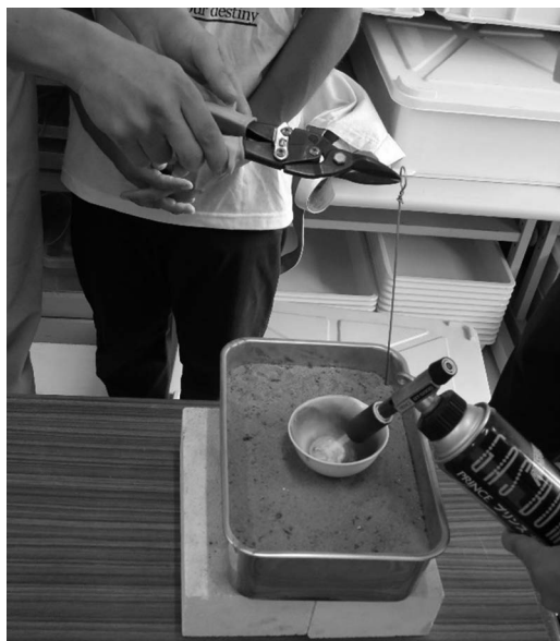
図1 ガスバーナーによる青銅(Cu-Sn合金)溶解の様子。
