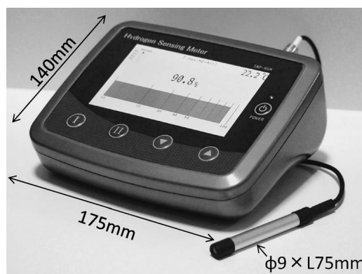
図7 ポータブル型水素濃度測定器(試作機).
