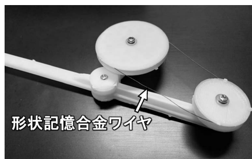
図7 形状記憶合金を使った熱エンジン.
