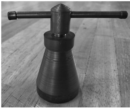
図1 金属加工実習Ⅱで製作するミニジャッキ.
