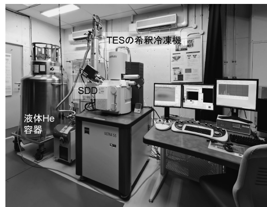
図4 TESを装着したSEM (ULTRA55). SDDも装着しており, 簡便にXEDS解析も可能である.
